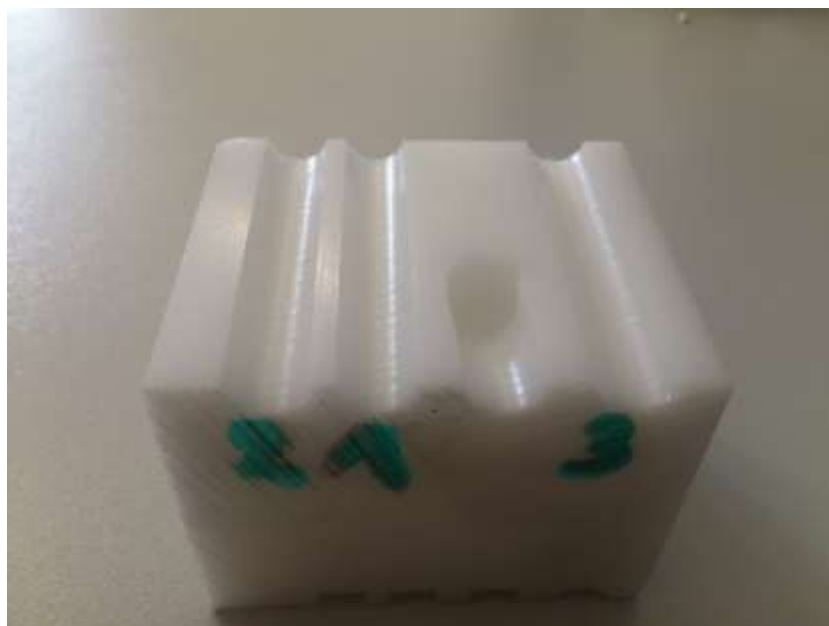
Slika 31: Testiranje števila vrtljajev na plastiki
