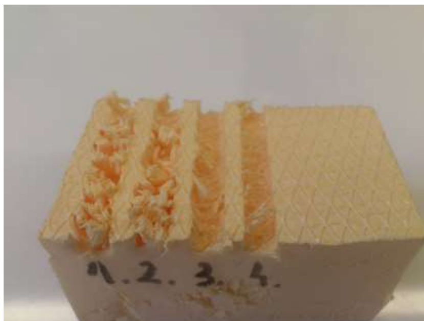
Slika 32: Testiranje števila vrtljajev rezkarja na stiroporu
