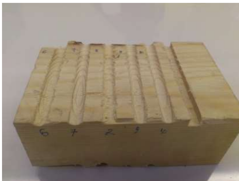
Slika 30: Testiranje števila vrtljajev rezkarja na lesu
