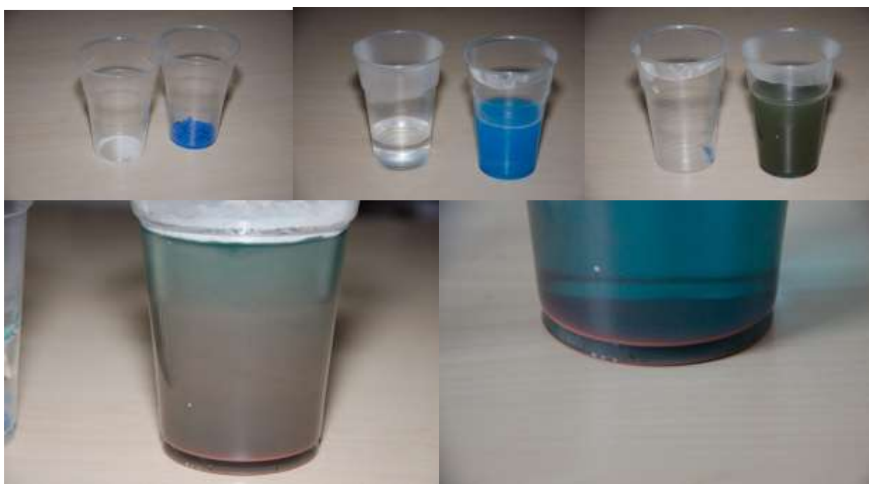
Slika 4: Priprava mešanice raztopin in izločanje bakra.
