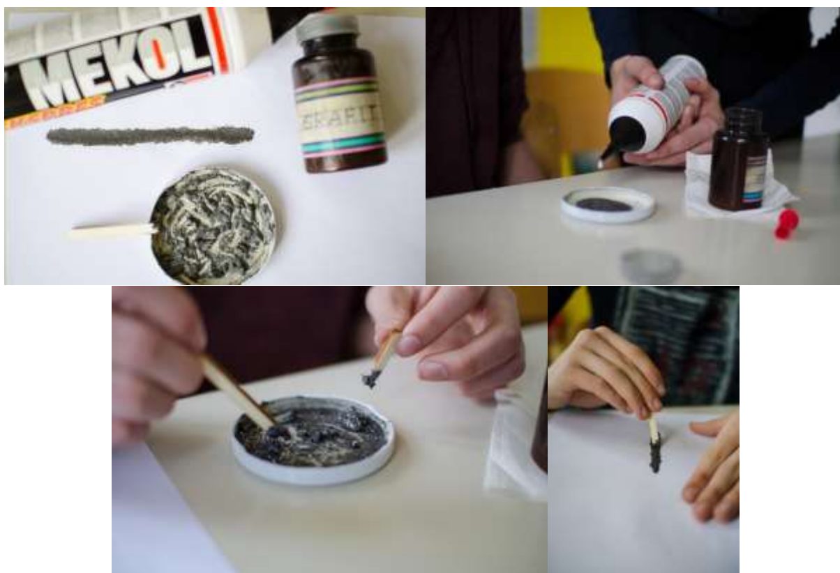
Slika 10: Izdelava in nanos barve iz Mekola in grafita.
