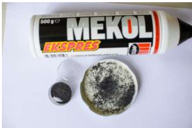
Slika 3: Sestavine za barvo iz svinčnikovega grafita, Mekola in železnih opilkov..
