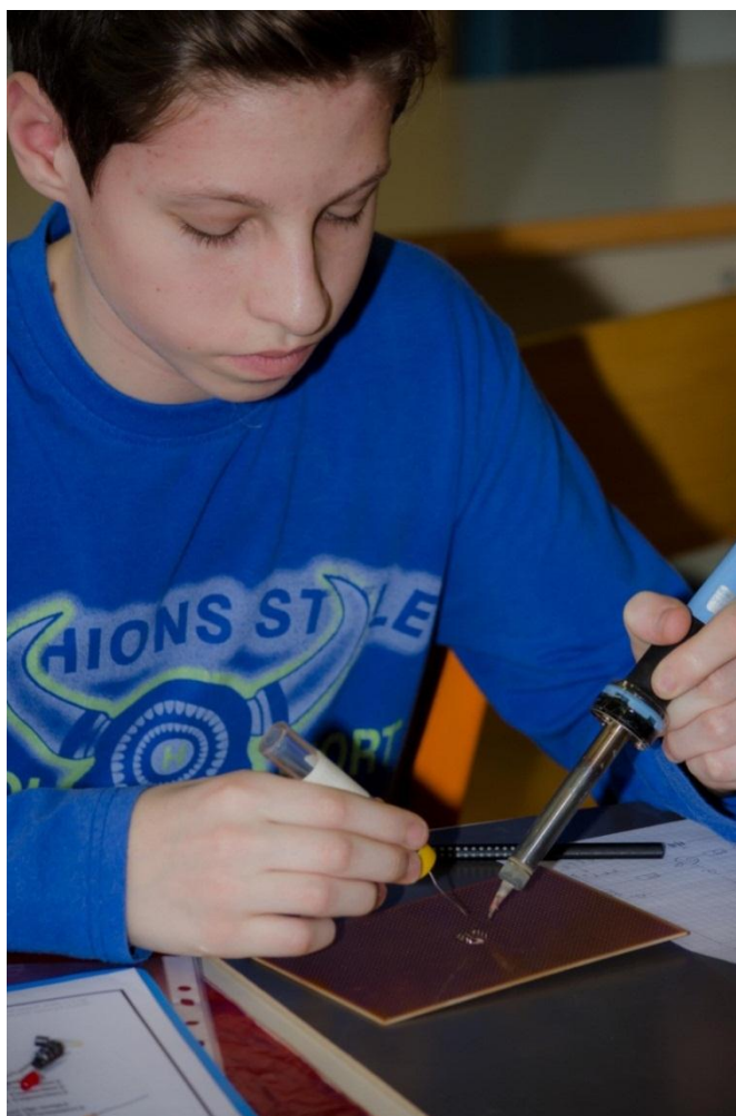
Slika 10: Spajkanje elementov na ploščico s tiskanim vezjem
