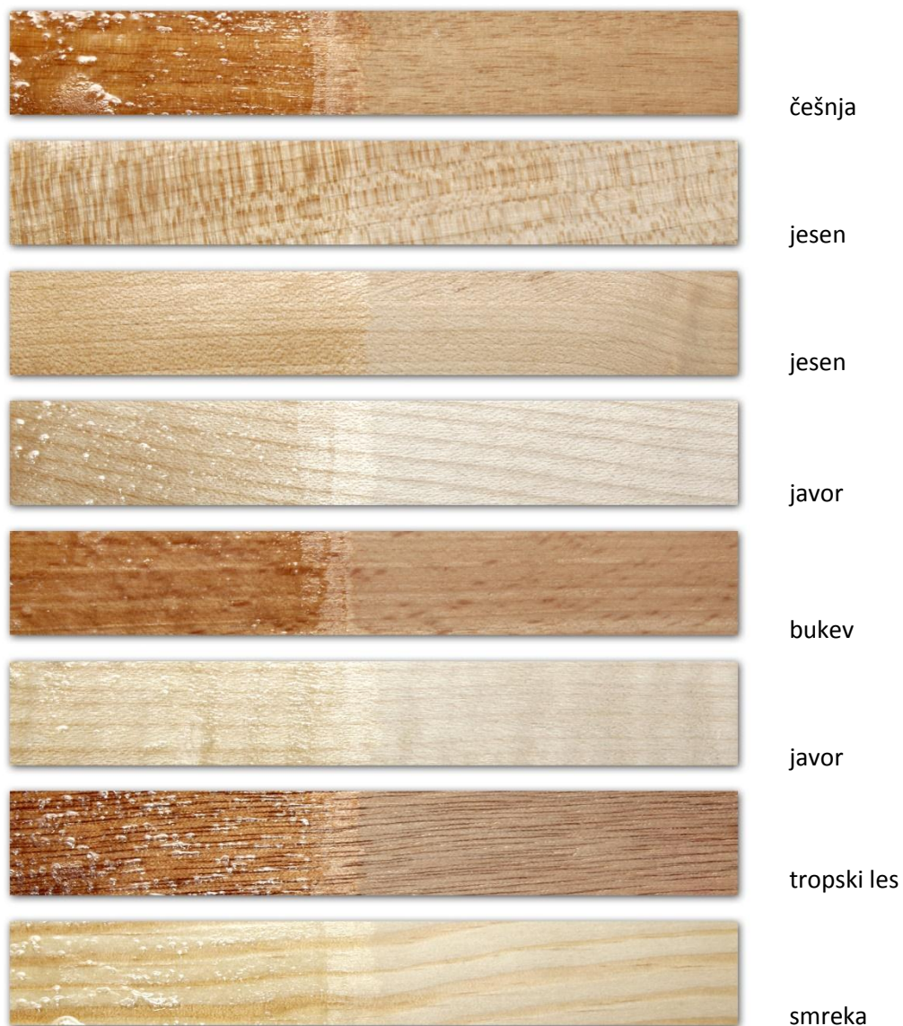
Slika 3: Videz letvic iz različnega lesa, desno brez premaza, levo s premazom
