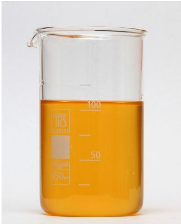
Slika 2: Izdelan lak iz kolofonije in acetona
