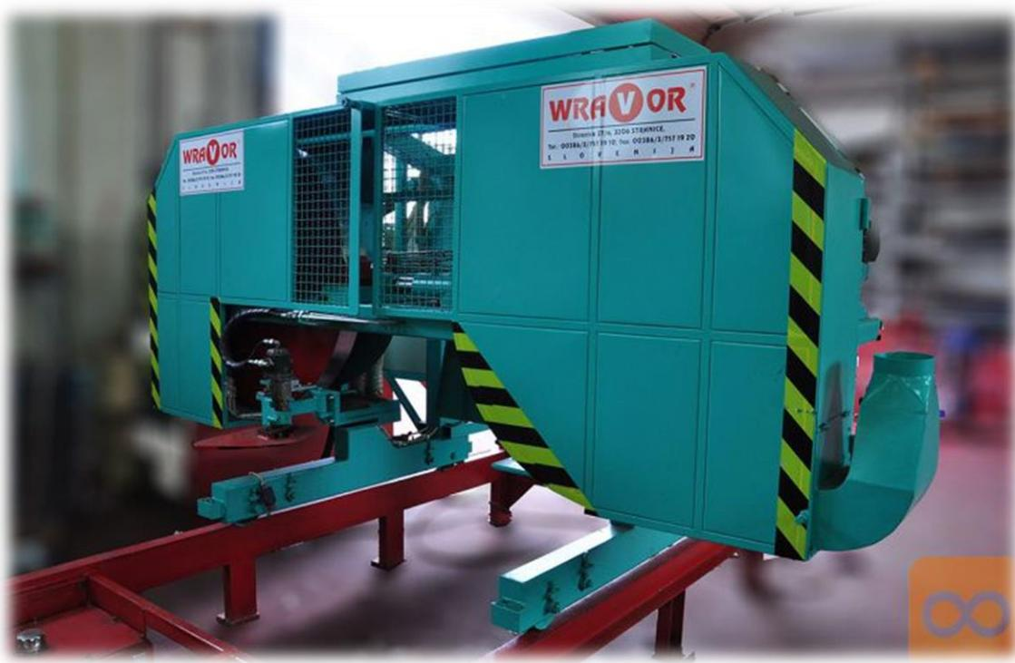
Slika 2: horizontalna tračna žaga
