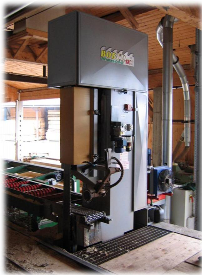
Slika 3: vertikalna tračna žaga
