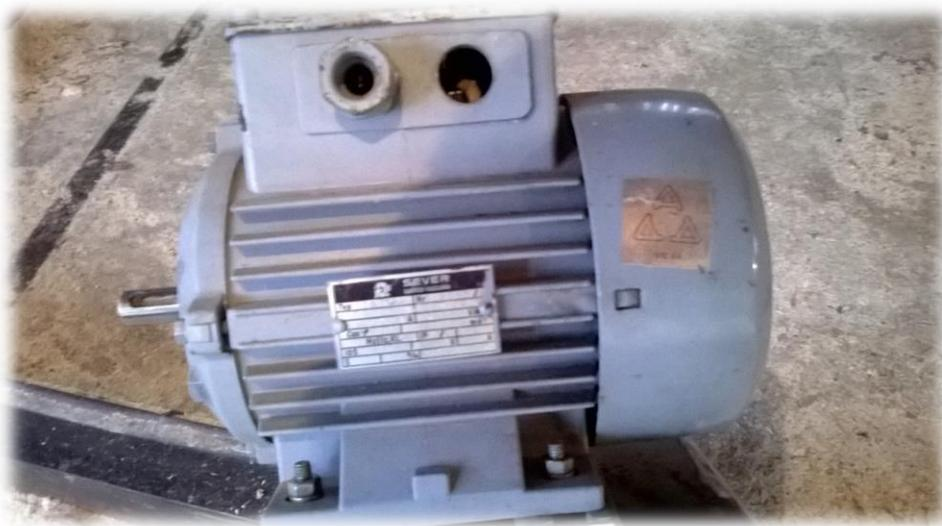
Slika 25: izmenični elektromotor
