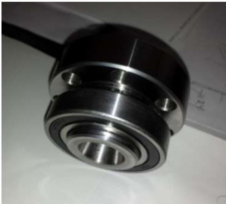
Slika 19: Končano pesto z ležajem
