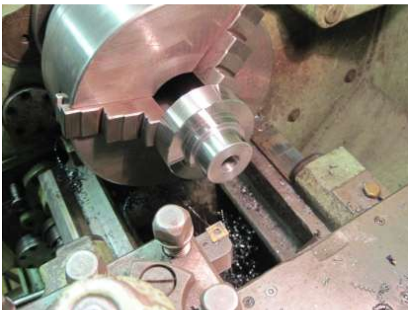
Slika 20: Grobo struženje pesta
