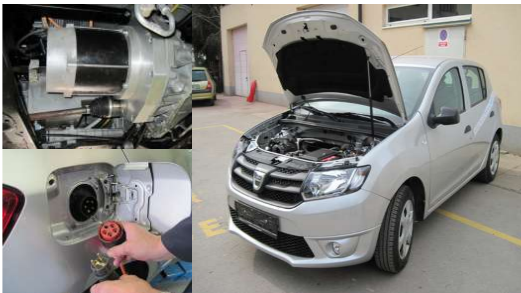
Slika 40: Vgrajeni motor v predelani Daciji
