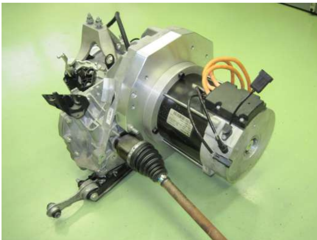
Slika 1: Predelani pogonski del motorja
