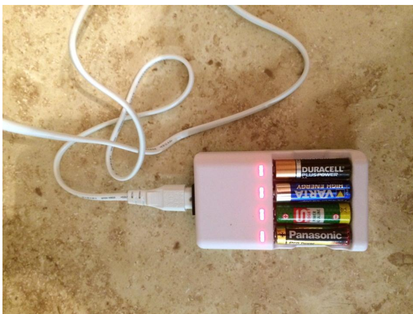
Slika 16: Polnjenje alkalnih baterij (rdeče signalne lučke)
