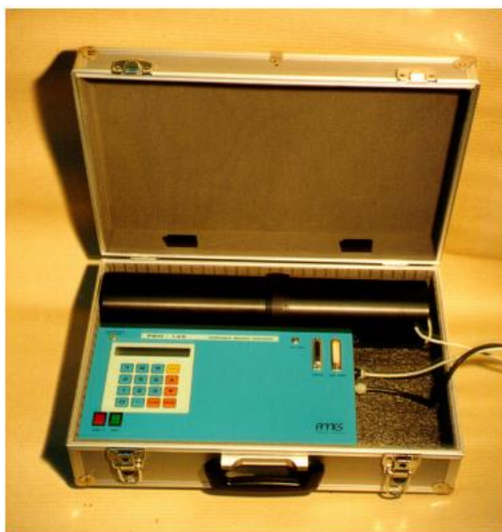
Slika 6: PRM 145 – prenosni merilnik radona, aktivna tehnika merjenja
