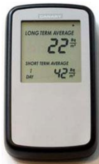
Slika 7: Canary – digitalni merilec povprečne koncentracije radona, aktivna tehnika merjenja
