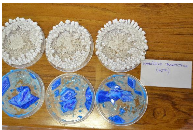
Slika 18: Primer izločanja kristalov za pripravljeno raztopino pri 40 °C deseti dan
