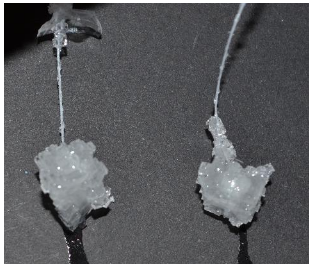
Sliki 11 in 12: Rast posamičnega kristala soli na vrvi s kristalom
