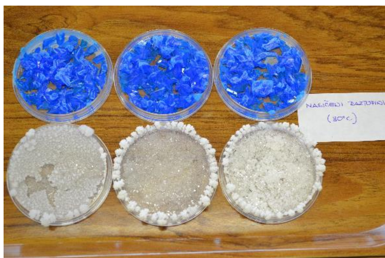
Slika 17: Primer izločanja kristalov za pripravljeno raztopino pri 80 °C osmi dan
