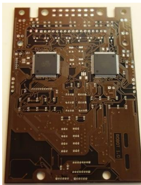
Slika 8: Plošča tiskanega vezja narejena po naših načrtih narisanih v programu Altium
