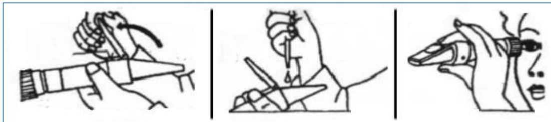
Slika 5: Nanašanje vzorca na prizmo refraktometra
