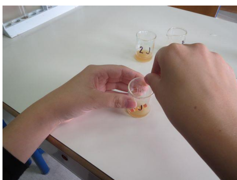
Slika 11: Določanje pH vrednosti jabolčnega soka
