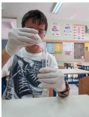
Slika 9: Dodajanje indikatorja fenolftaleina
