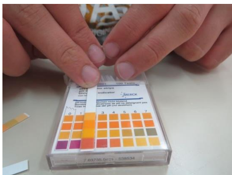
Slika 12: Odčitavanje pH vrednosti jabolčnega soka
