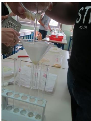
Slika 3: Precejanje jabolčnega soka skozi filtrirni papir
