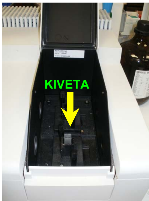
Slika 7: Vstavitev kivete v spektrofotometer (fotografija last avtorjev)
