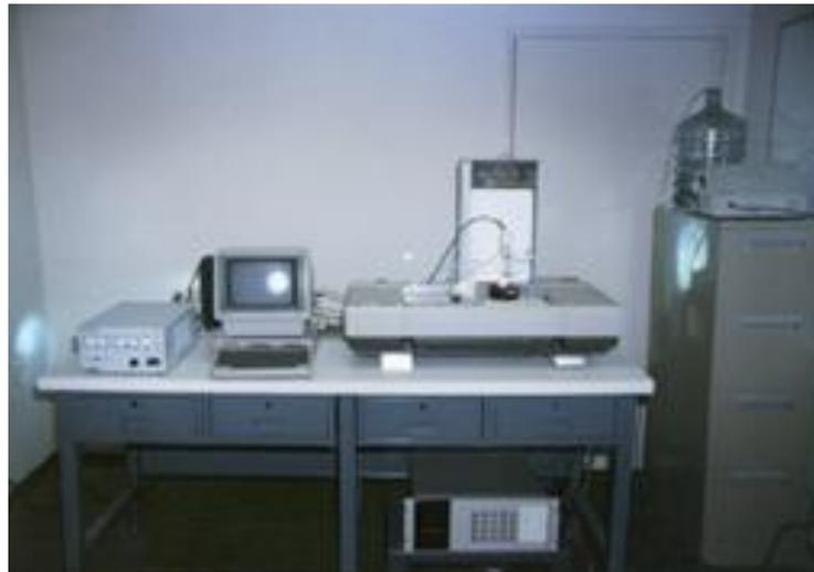
Slika 29: SLA tiskalnik [18]
