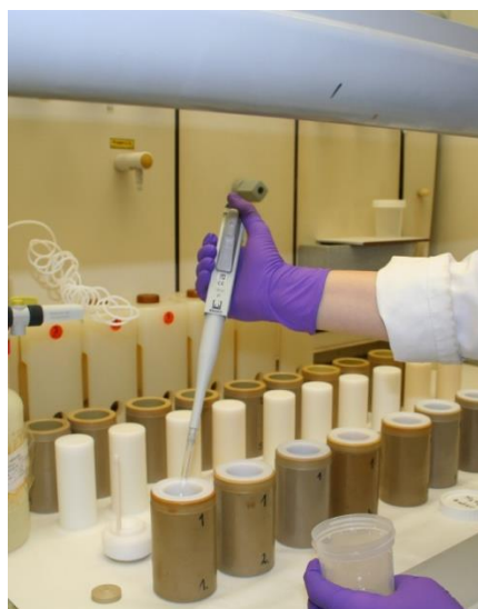
Slika 41: Dodajanje \text{H}_2\text{O}_2 z avtomatsko pipeto
