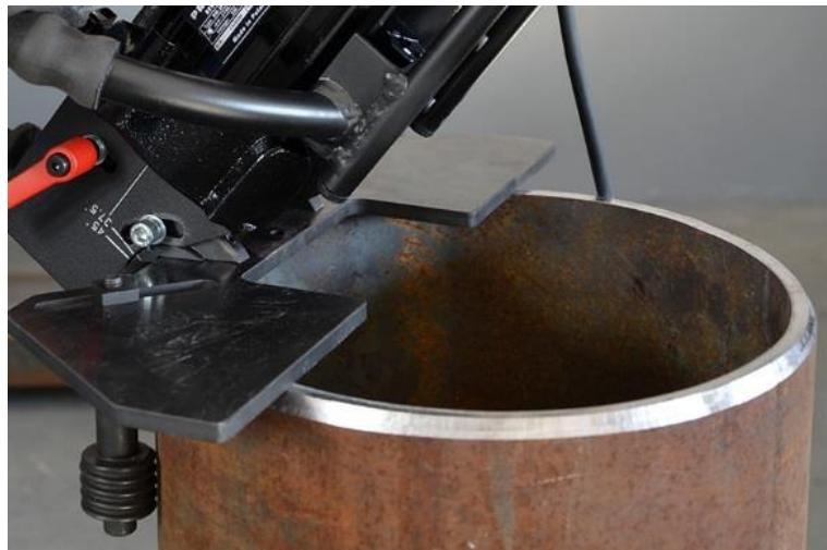
Slika 4: Ročna naprava za posnemanje robov [6]
