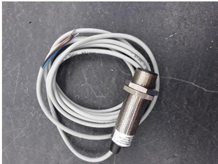
Slika 31: Induktivni senzor
