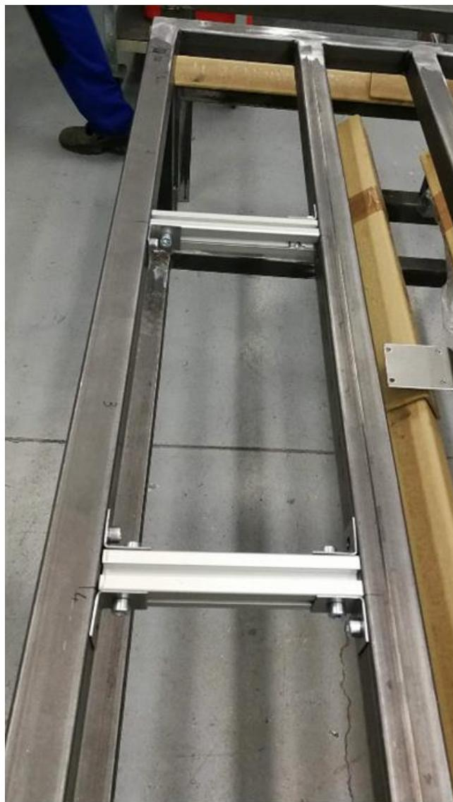
Slika 17: Nosilca stabilizatorjev
