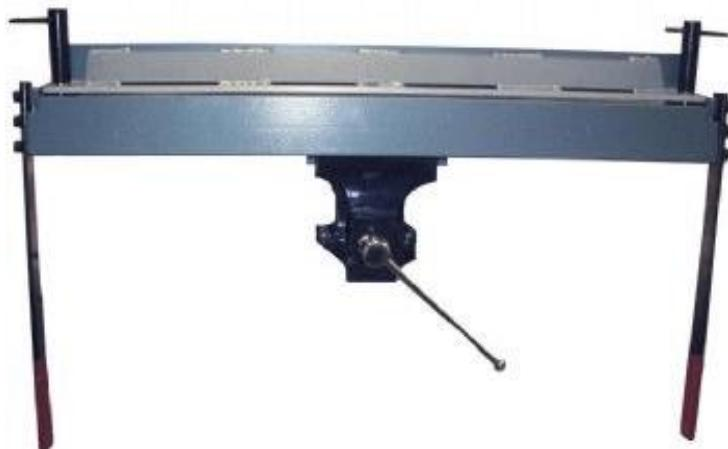
Slika 2: Naprava za posnemanje robov, ravno krivljeno jeklo in pločevino [5]
