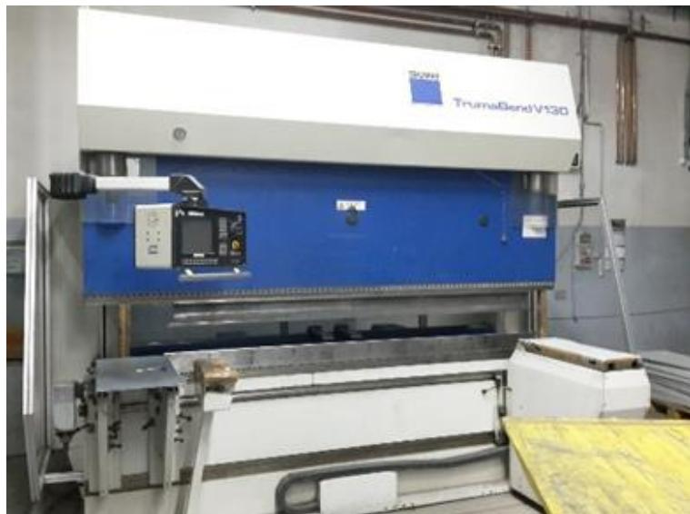
Slika 44: Naprava za upogibanje pločevine
