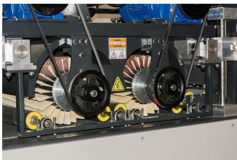
Slika 3: Naprava za brušenje pločevine [13]
