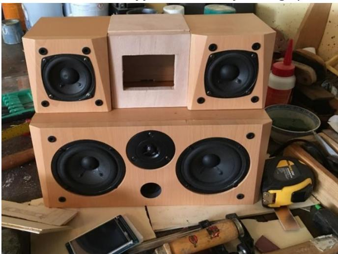
Slika 8: Izgled ohišja med izdelavo
