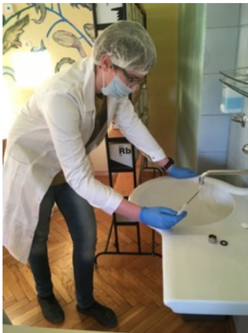
Slika 13: Meritve temperature vode na izlivnem mestu
