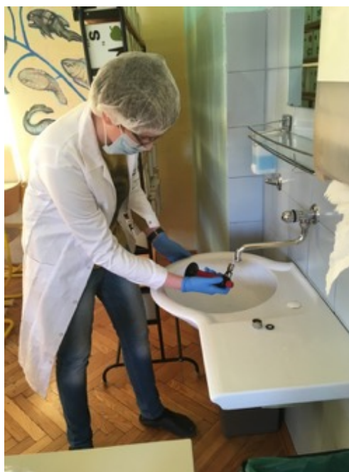
Slika 10: Obžig notranjih in zunanjih površin pipe s plinskim gorilnikom
