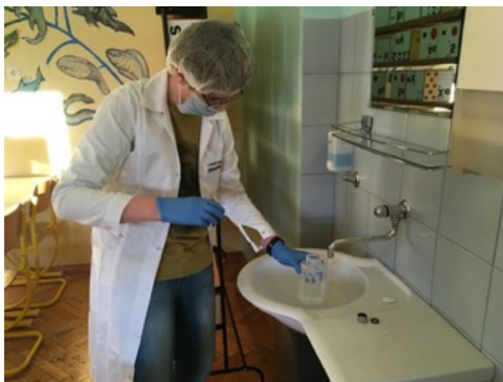
Slika 14: Sterilni odvzem vzorca na mikrobiološke parametre
