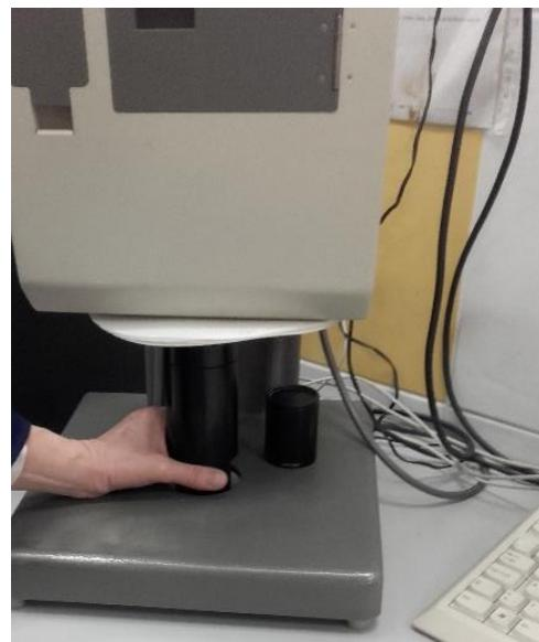
Slika 27: Merjenje prepustnosti svetlobe s spektrometrom [osebni arhiv]
