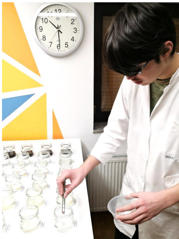
Fotografija 9: Vstavljanje vzorcev kovinskih materialov v steklene posode s tekočino (avtor: Nataša Koštomaj)
