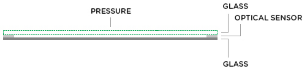
Slika 9: Zgradba optičnega zaslona na dotik
