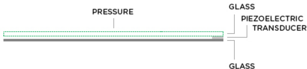
Slika 11: Zgradba zaslona za zaznavanje impulza na zvočni sistem (Vir: http://m.si.make-sign.com/info/the-different-types-of-touch-screen-36471150.html , dostop 12.1.2021)
