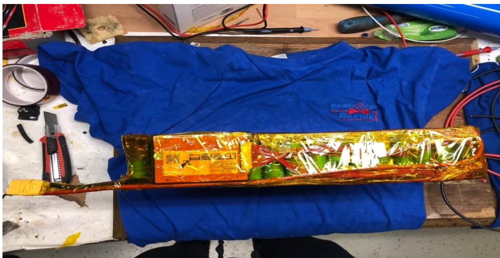
Slika 27: Povezava BMS sistema z baterijskim sklopom (osebni vir)
