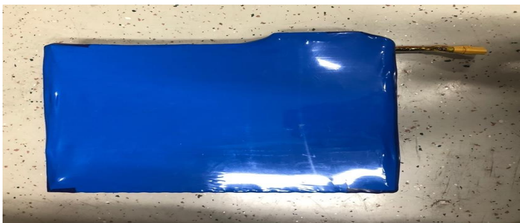
Slika 28: Končno sestavljen baterijski sklop (osebni vir)
