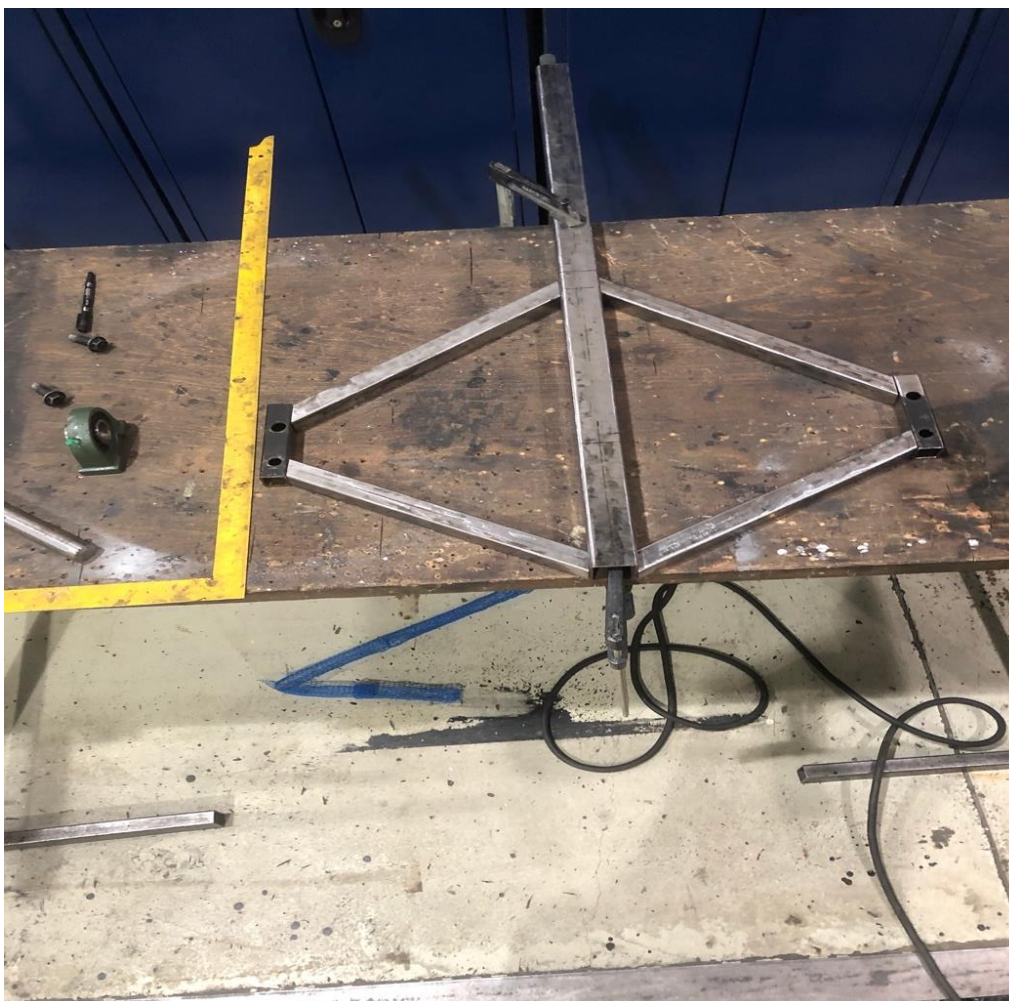
Slika 16: Zadnja konstrukcija pred varjenjem (osebni vir)
